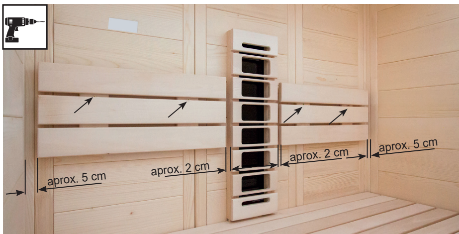
Broca de 3 mm, 4 parafusos de 4 x 70 mm
